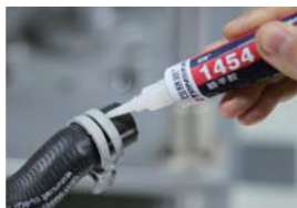
汽车胶管与钢质卡箍粘接
